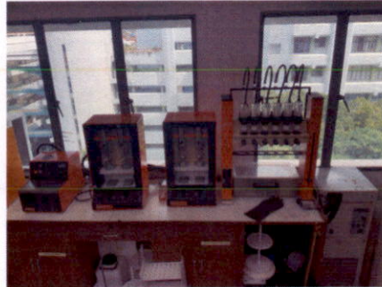
ชื่อ : เครื่องวิเคราะห์ไขมันและน้ำมัน (ยี่ห้อ Teacator รุ่น 1045 HT2)
