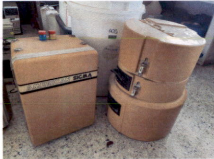
ชื่อ : เครื่องเก็บตัวอย่างน้ำเสีย SIGMA รุ่น 6200
