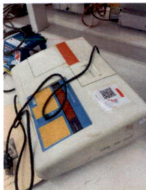
ชื่อ : เครื่องวัดความขุ่น (ยี่ห้อHACH รุ่น 2100 AN)
